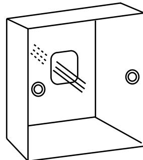
3. Fije la tapa trasera al soporte. A continuación, conecte el cable de comunicación al puerto CON1 del controlador con cable. Por último, coloque la cubierta frontal del controlador con cable sobre la cubierta trasera para completar la instalación.
